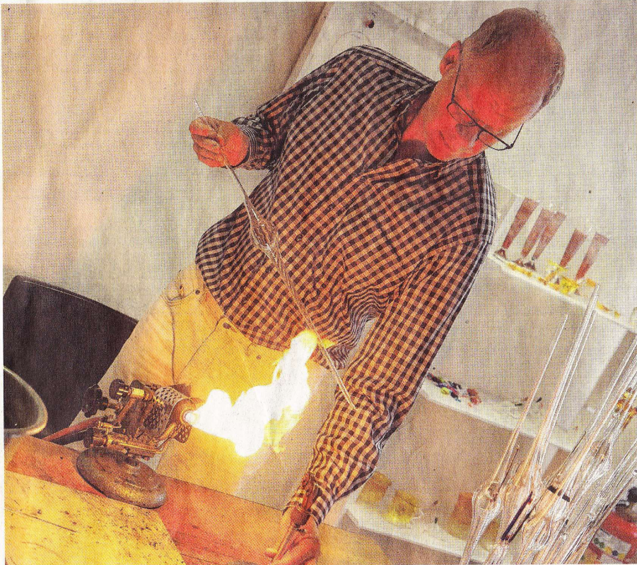
Vorsichtig und sorgsam werden die Teile unter ständiger Bewegung über einem Brenner auf mehr als 500 Grad erhitzt. Fotos: Tom
